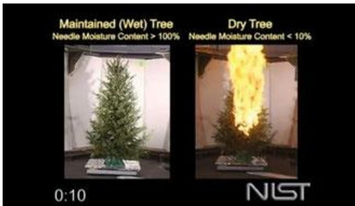
Zum Bild: Ein Brandversuch des NIST zeigt das Gefahrenpotential eines extrem trockenen Christbaums nur zehn Sekunden nach der Entzündung. Für ein Video zu einem weiteren Brandversuch der US-Bundesbehörde klicken Sie auf das Bild.
